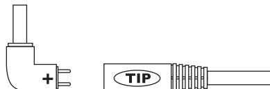
W przypadku urządzenia o polaryzacji ujemnej (-) umieść złączkę w następujący sposób:
