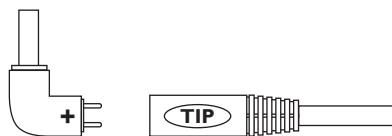
Is uw apparaat center negatief (-) plaats dan de connector als volgt:
